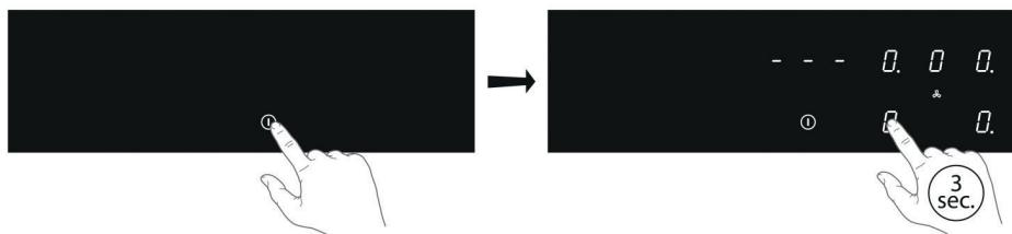
3. Suelte y deslice el dedo de 0 a 9 por el control deslizante.
