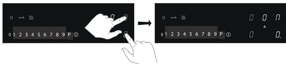
3. Ajuste el nivel de potencia con el control deslizante.
