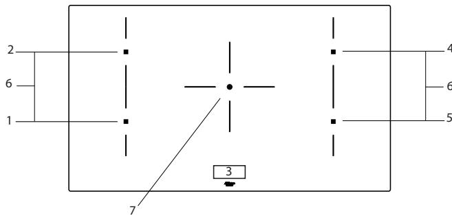
1. Zona cottura anteriore sinistra 210 x 190 mm / 2,1 kW (boost 3,0 kW)
