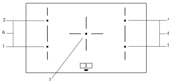
1. Zone de cuisson avant gauche 210 x 190 mm / 2,1 kW (boost 3,0 kW)
